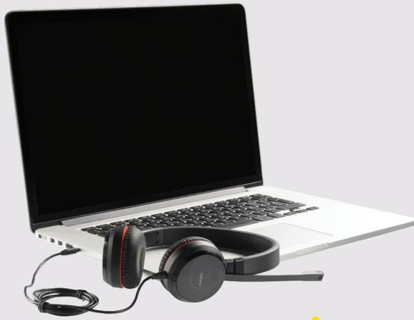
Schließen Sie das Evolve 30 an den USB-Anschluss Ihres Computers an oder verbinden Sie das Headset ohne die integrierte Steuereinheit direkt mit dem 3,5-mm-Klinkenstecker\*
