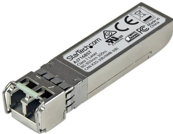
Das AJ716BST ist ein HP AJ716B-kompatibles Glasfaser-Transceiver-Modul, das speziell für die Zusammenarbeit mit HP®-Switches und -Router entwickelt, programmiert und getestet wurde. Es liefert zuverlässige 10-GbE-Konnektivität über Glasfaserkabel für 8GFC-konforme Netzwerke mit einer maximalen Entfernung von bis zu 300 m.
