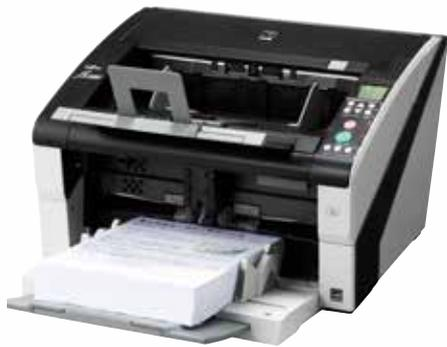
A4-Querformat mit 300 dpi: 100 Seiten/min bzw. 200 Bilder/min
