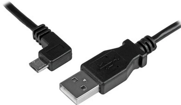
Mit 0,2mm<sup>2</sup> Draht bietet Ihnen dieses Micro-USB-Kabel den gesamten Strom, den Sie benötigen, um Ihre Mobilgeräte schneller aufzuladen. Das Kabel ist mit einem linksgewinkelten Micro-USB-Stecker versehen, sodass Sie es ausgezeichnet für den Ladevorgang Ihrer Mobilgeräte in einem Auto nutzen können. Auch der Zugriff auf Ihr Mobilgerät bleibt möglich, während es an ein Ladegerät im Auto oder am Computer angeschlossen ist.
