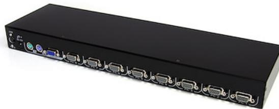
Dieses 8-Port-KVM-Modul ist für die StarTech.com-Serie von Rack-Montage-LCD-Konsolen geeignet und ermöglicht die Steuerung von acht Servern von einem einzigen Standort aus. Sie können eine LCD-Konsole mit einem Anschluss aufrüsten oder eine fehlerhafte Konsole ersetzen (siehe unsere Liste von kompatiblen LCD-Konsolen).
