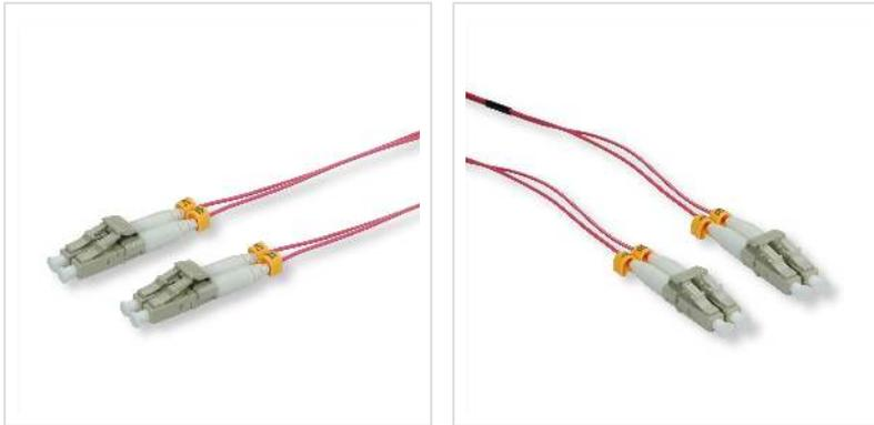
**Extra dünne ROLINE LWL-Patchkabel in OM4-Qualität für hoch performante LWL-Verkabelung in hochdichten Umgebungen. Der LC-Stecker mit seinem kleinen Querschnitt erlaubt hohe Dichten im Verteilerbereich. Und die extra dünnen Kabel haben gerade einmal 1,2mm Außendurchmesser je Faser!**
