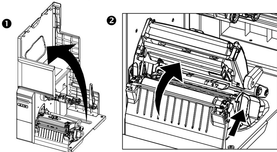
Loading Media/安裝標籤/安裝标签/メディアの読み込み/Загрузка носителя/Medien werden
