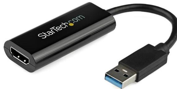
Der Slim USB 3.0-auf-HDMI-Adapter USB32HDES wandelt einen USB 3.0-Port in einen HDMI-Ausgang mit Unterstützung von Videoauflösungen bis zu 1920x1200/1080p. Der Adapter minimiert Unordnung durch ein schlankes Design, das hervorragend zum Videokabel passt, und ist somit eine ideale, zeitsparende Lösung für Anwendungen mit mehreren Monitoren mit Ultrabook™, Laptops oder Desktop-Computern.
