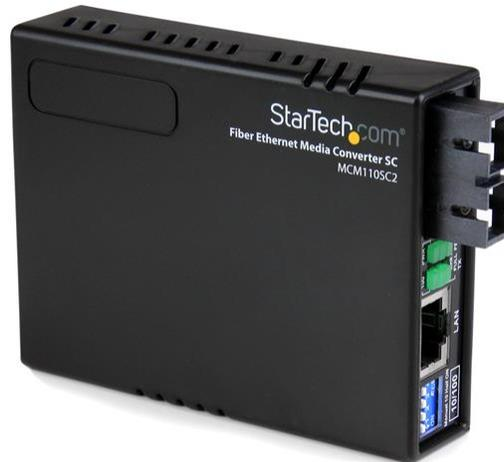
Der MCM110SC2EU 10/100 Multimodus Faseroptik-Ethernet-Medienkonverter (SC, 2 km) stellt eine kostengünstige Ethernet-Faseroptik-Verbindung her und konvertiert auf transparente Weise auf/von 10Base-T oder 100Base-Tx Ethernet-Signale/n und 100Base-Fx optischen Signale/n, um eine Ethernet-Netzwerkverbindung über eine SC-terminierte Multimodus-Faseroptik-Hauptleitung herzustellen.
