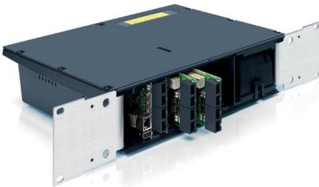
**Kleines Format, große Leistung:** Mit der COMpact 5500R lassen sich 14 Amtgespräche gleichzeitig über VoIP, ISDN und/oder analog führen. Bis zu 32 IP-Kanäle (im Vollausbau) machen die COMpact 5500R zur reinrassigen VoIP-Appliance.
