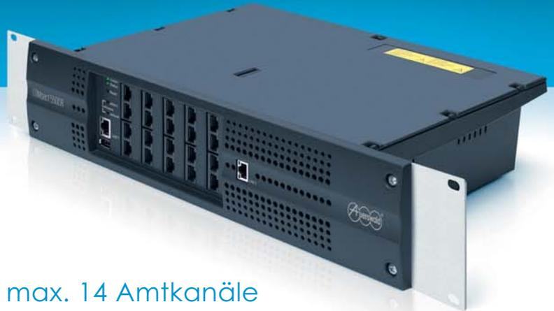
Vollmodulare VoIP-Appliance für max. 14 Amtkanäle und max. 50 Teilnehmer, mit Erweiterungsmöglichkeiten für ISDN- und POTS-/FXO-Amtkanäle und Gateways für Analog- und ISDN-Teilnehmer, im 19"-Gehäuse mit 5 Steckplätzen.
