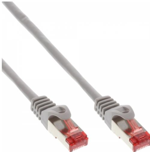
Twisted-Pair-Netzwerkkabel der Kategorie Cat.6 zur Verbindung von Netzwerk-Komponenten mit RJ45-Anschlüssen, wie Switches, Router, Dosen, Patchpanel, Netzwerkkarten. Geeignet für Gigabit-Verbindungen (1Gbps) bei einer Frequenz von max. 250Mhz.
