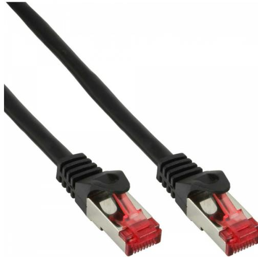
Twisted-Pair-Netzwerkabel der Kategorie Cat.6 zur Verbindung von Netzwerk-Komponenten mit RJ45-Anschlüssen, wie Switches, Router, Dosen, Patchpanel, Netzwerkkarten. Geeignet für Gigabit-Verbindungen (1Gbps) bei einer Frequenz von max. 250Mhz.
