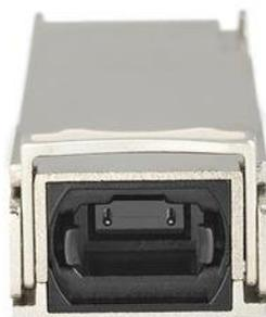
Der QSFP40GESR4E ist ein Juniper QSFP40GER4ES-kompatibles Glasfaser QSFP-Transceiver-Modul, das für den Einsatz mit Juniper® Marken-Switches und -Routern entwickelt, programmiert und getestet wurde. Es sorgt für zuverlässige 40 GbE-Konnektivität über Glasfaser-Kabel für 40GBase-SR4-konforme Netzwerke mit einer maximalen Entfernung von bis zu 400m.
