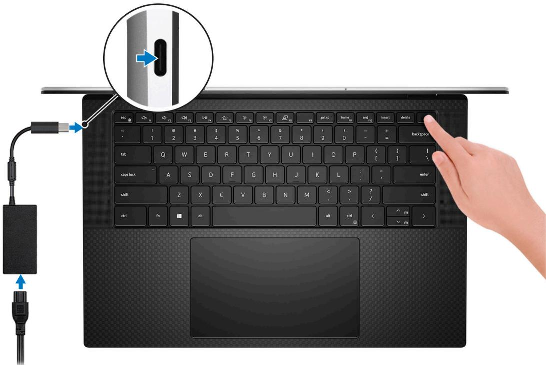
**ANMERKUNG:** Sie können Ihr System aufladen, indem Sie den Netzadapter an einen der Thunderbolt 3-Ports (USB Typ-C) anschließen, die sich auf der linken Seite Ihres Computers befinden, oder mit dem USB 3.2-Gen-2-Port (Typ C), der sich auf der rechten Seite Ihres Computers befindet.
